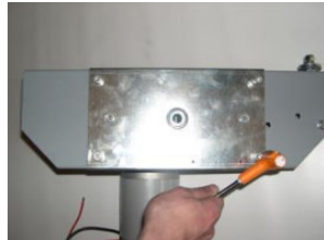
1 Dévisser les 4 vis du couvercle de protection avec une clé hexagonale de 6 mm
