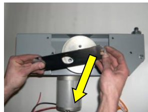
5 Enlever l'étrier du roulement.
