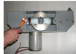
3 Dévisser, avec la même clé hexagonale, les deux vis de l'étrier de renfort de l'arbre moteur.
