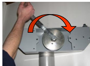
8 Maintenant l'arbre moteur et le réducteur sont débloqués de la poulie et on peut procéder à l'entraînement manuel de la bâche.
