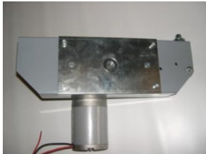
1 Dévisser les 4 vis du couvercle de protection avec une clé hexagonale de 6 mm
